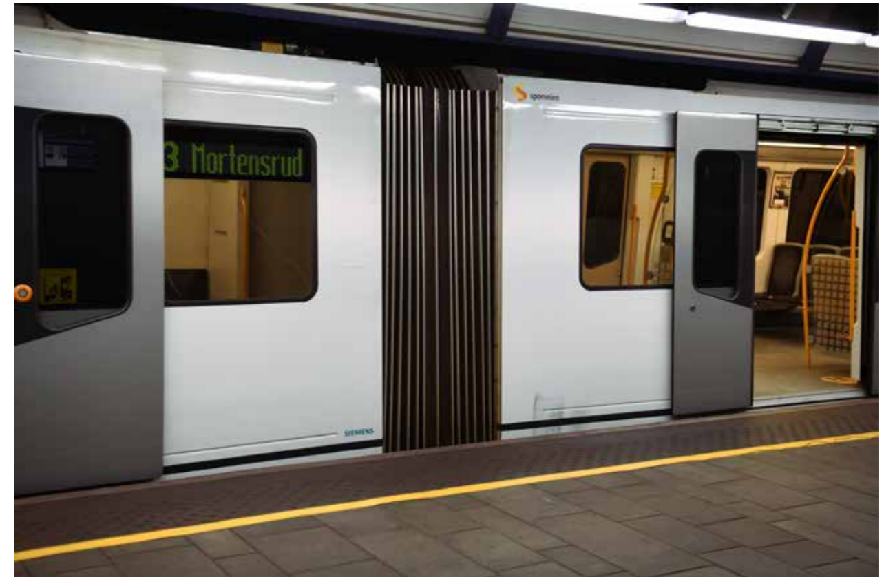
Sporveien jobber målbevisst med sikkerheten for medarbeidere og reisende. I fjor ble en løsning for å montere en ny utvendig sikkerhetsbelg godkjent. I år starter Sporveien arbeidet med å montere den nye sikkerhetsbelgen på alle T-banetrogene. Belgen reduserer risikoen for fall mellom tog og plattform.
